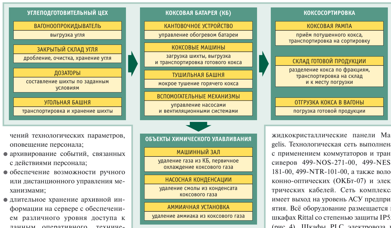
Рис. 2. Архитектура системы управления объектами комплекса
