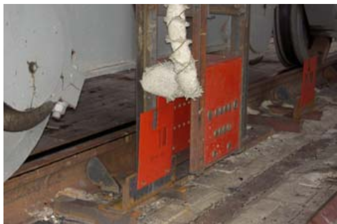
Рис. 9. Позиционирование коксовой машины с использованием датчиков и кодовых пластин
